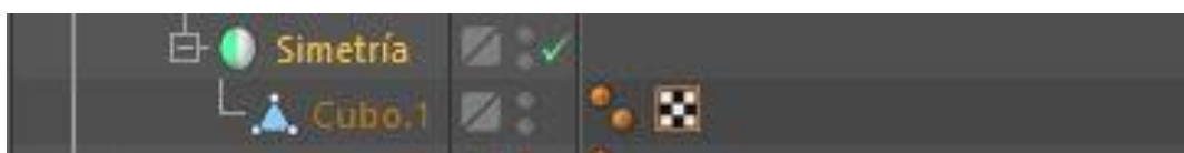
Figura 82. Colocación del objeto dentro del objeto Simetría para aplicar el efecto de la herramienta sobre el mismo
