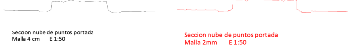
Fig. 6: Sección obtenida a partir de la nube de punto con una resolución de malla de 4cm
