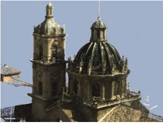
Fig. 1: Modelo de nube de puntos 3D de la cúpula y torre de la Iglesia de S. Justo y Pastor (Granada), mediante escáner laser -Scan Station2, Leica-. Resolución de malla de 5mm. Fuente: José Antonio Benavides
