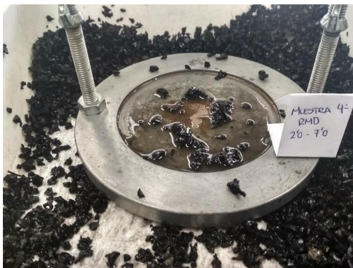
Figura 6: Imágenes de ensayos proctor con 20% de agua
