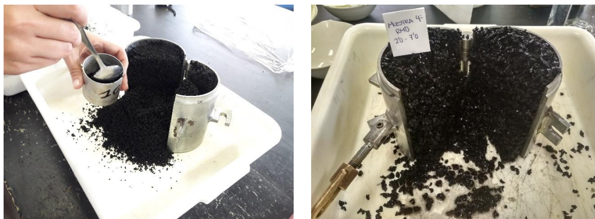
Figura 3: Imágenes del ensayo Proctor
