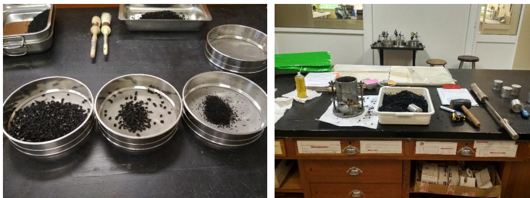
Figura 2: Imágenes del ensayo granulométrico
