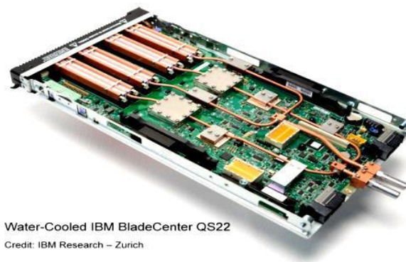
Figura 2. Sistema refrigerado por líquido de IBM.
