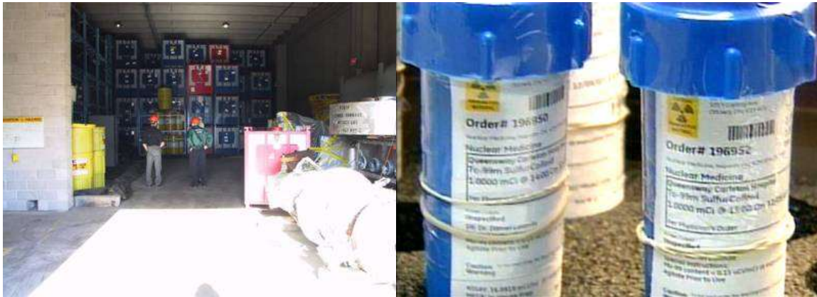
Figura 3. A la izquierda, un almacén superficial para residuos de baja actividad. Muchos productores de estos residuos son responsables de su gestión, construyendo las estructuras necesarias para su almacenamiento. A la derecha, ejemplos de residuos con un tiempo de vida muy corto (como los procedentes de los hospitales), individualmente etiquetados para ser desplazados a sus correspondientes almacenes. [7]
