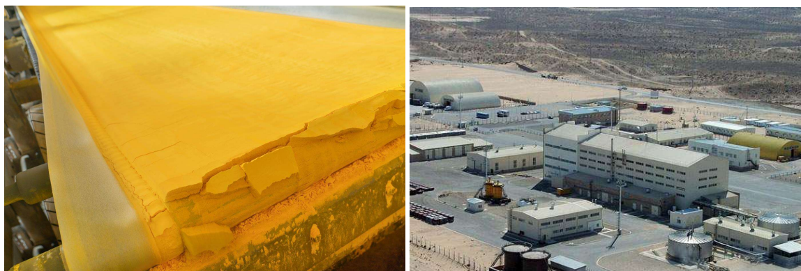
Figura 10. Yellow cake sobre cinta, en la planta industrial de Muyunkum. El mineral extraído de las menas de uranita se tritura finamente y el uranio se extrae mediante una serie de operaciones químicas. Esto se conoce como “procesamiento”, siendo el resultado la conocida pasta amarilla, conteniendo un 75% de óxido de uranio \text{U}_3\text{O}_8 . [12] A la derecha, imagen de la planta, con una producción anual entre 1,500tm y 4,000tm de uranio.
