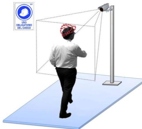
Figura 3.4. Comprobación del uso de EPIs con visión artificial.
