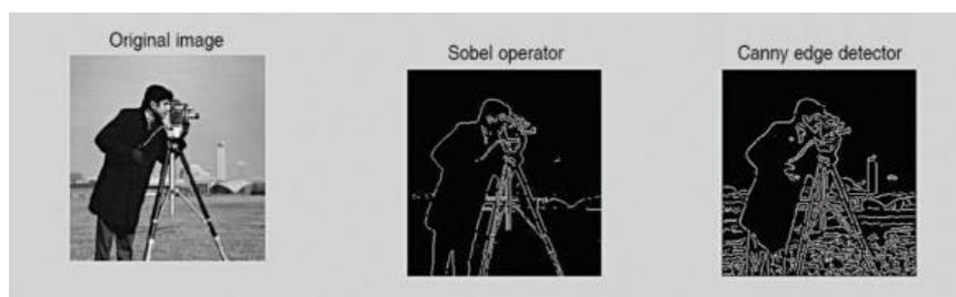
Figura 4.6. Comparativa de operador Canny y Sobel. [Fuente: Adaptación de Taibani (2019)]
