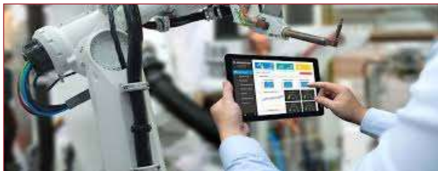
6. Monitorización de condiciones de funcionamiento de un robot autónoma, a través de programa GMAO implantado en tablet.
