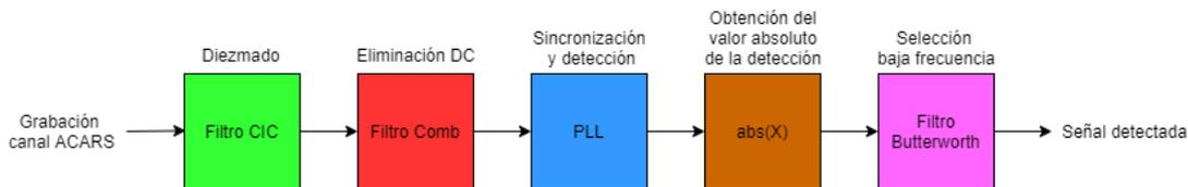
Figura 5.1 Estructura de la detección de ACARS.
