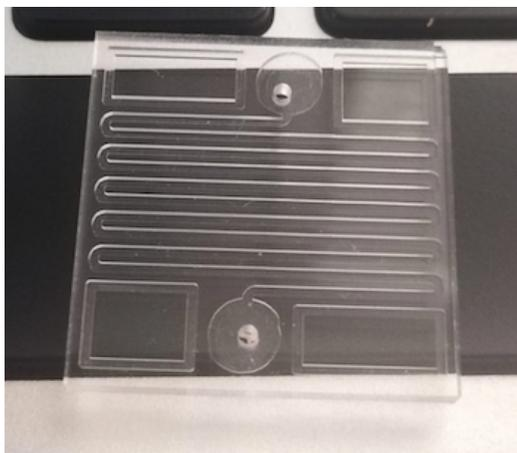
Figura 4.22 LOC fabricado en PMMA
