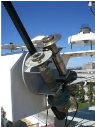
Figura 3-11. Pirheliómetro Eppley NIP
