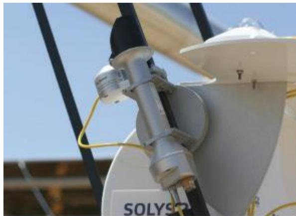
Figura 3-10. Pirheliómetro Kipp & Zonen, modelo CHP1, con seguidor
