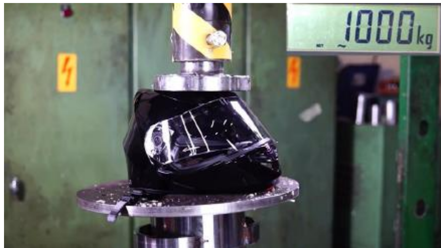
Figura 30. Prueba Rigidez Casco con Compresión [Fuente: Induscascos 2012]
