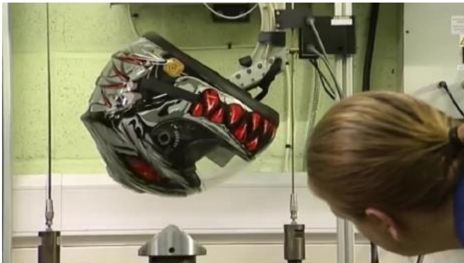
Figura 32. Prueba Resistencia Mecánica en Cuña [Fuente: Inducascos 2012]
