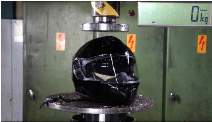
Figura 29. Prueba Rigidez Casco sin Compresión [Fuente: Induscascos 2012]
