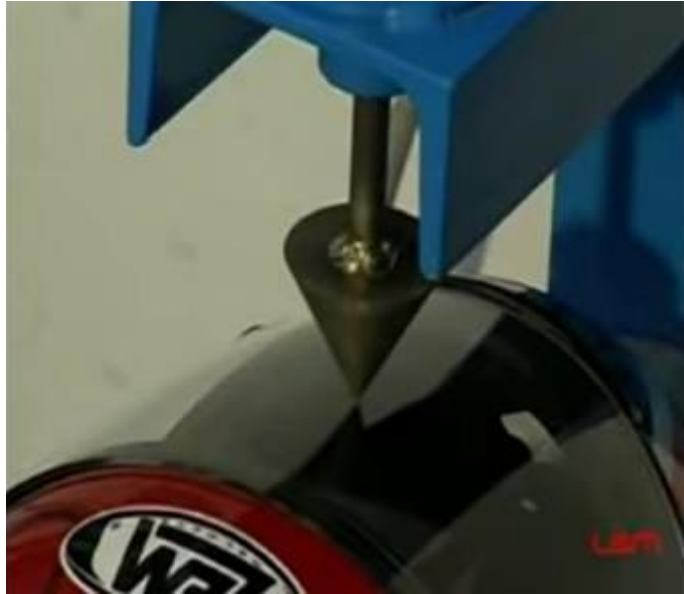
Figura 33. Prueba Resistencia Mecánica a la Visera [Fuente: Inducascos 2012]
