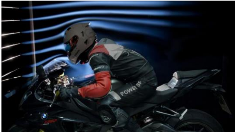
Figura 35. Prueba en Túnel de Ventilación [Fuente: Revista moto 2015]
