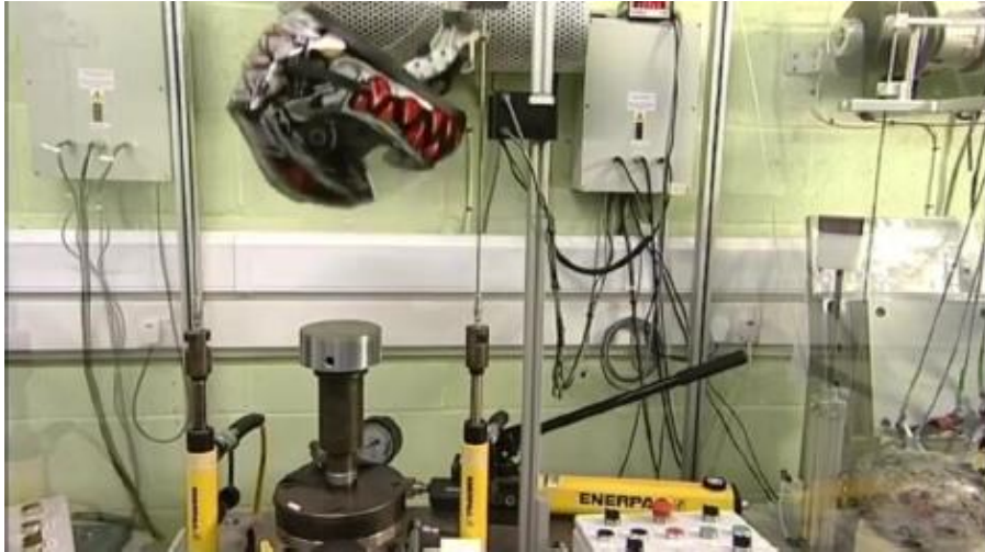
Figura 31. Prueba Resistencia Mecánica en Superficie Plana [Fuente: Inducascos 2012]
