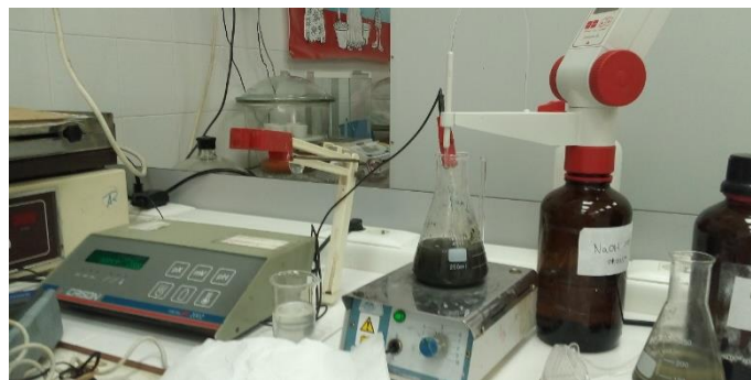
Figura 11. Adición de ácido para hallar la alcalinidad
