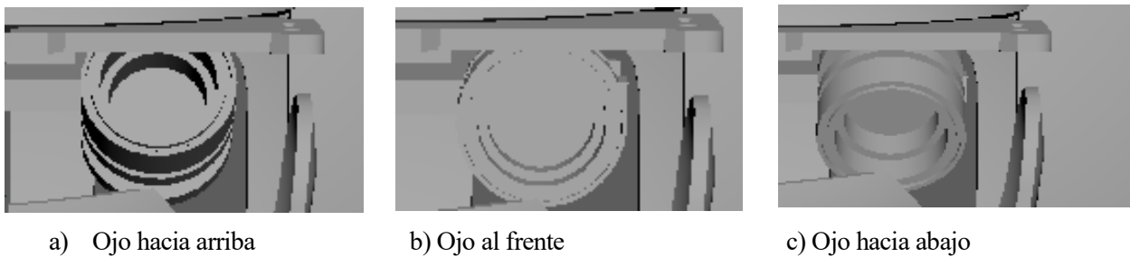
Figura 3-4. Tres posiciones posibles del ojo derecho del robot
