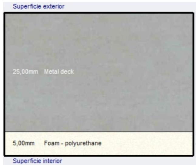
Ilustración 44. Composición constructiva de la cubierta. Fuente: elaboración propia mediante programa DesignBuilder.
