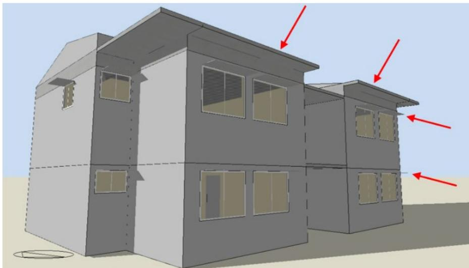
Ilustración 115. Perspectiva de la vivienda con cámara de aire, voladizos sobre las ventanas, extensión de cubierta y vidrios bajo emisivos. Fuente: elaboración propia mediante programa DesignBuilder.
