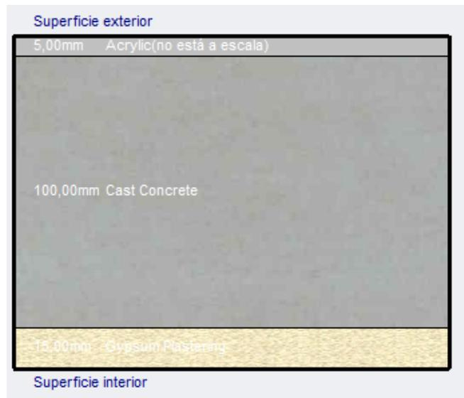
Ilustración 41. Detalle de los componentes constructivos del muro. Fuente: elaboración propia mediante programa DesignBuilder.
