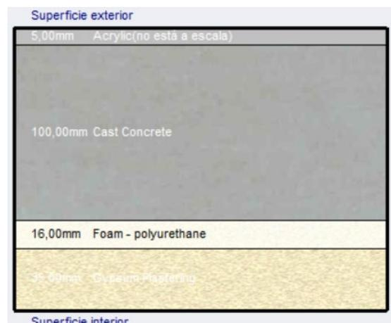
Ilustración 89. Sección del muro con aislamiento. Fuente: elaboración propia mediante programa DesignBuilder.
