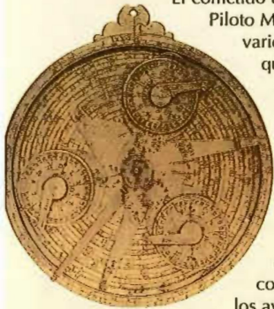
El astrolabio-ecuatorial se utilizaba para conocer las coordenadas del barco en alta mar.
