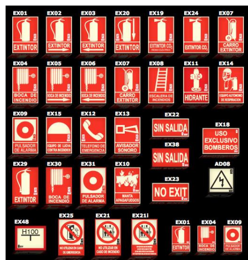
Figura 50. Señalización de las instalaciones manuales de protección contra incendios DB SI-4 2 CTE.
