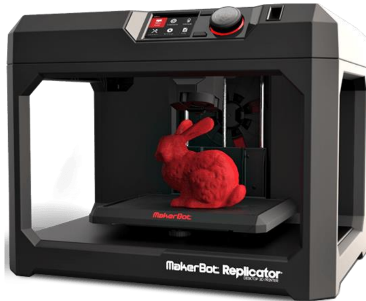
Figura 2.5. Impresora 3D. Filamento de ABS (Acrilonitrilo butadieno estireno)
