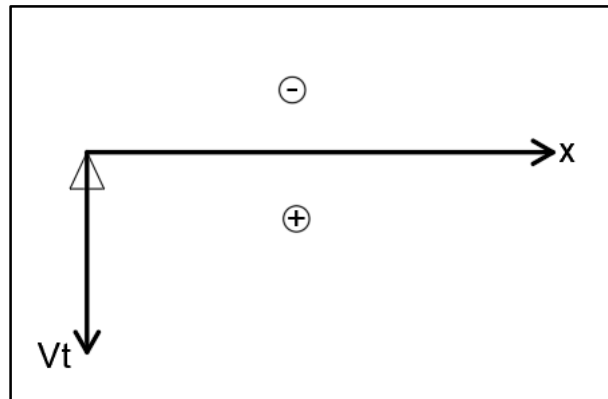
Figura 5-5. Criterio de signo diagrama esfuerzo cortante transversal. Carga de Viento
