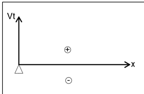
Figura 5-2. Criterio de signo diagrama esfuerzo cortante transversal. Carga excéntrica
