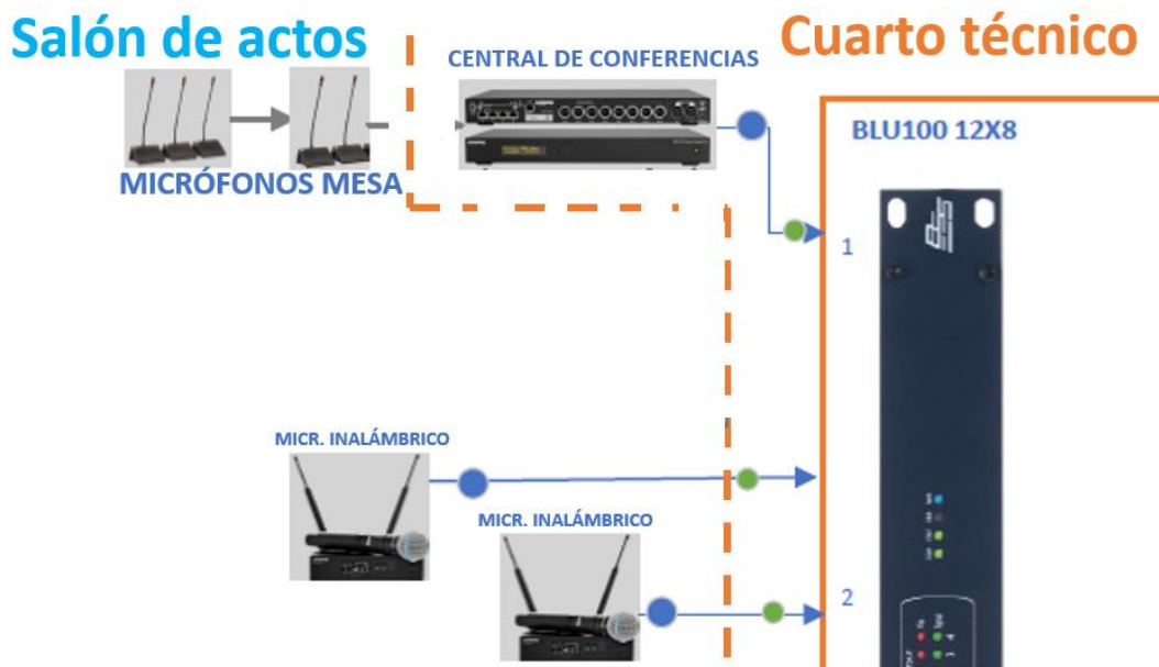
Figura 64. Conexión del sistema de microfonía. Las flechas grises indican que se conectan mediante cable ethernet, mientras que el azul representa un cable de audio de tres hilos balanceado. El punto azul indica que esa salida es una salida XLR, mientras que el punto verde indica una conexión clemática. Los números de la figura representan la entrada del procesador de audio.
