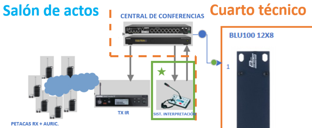
Figura 68. Conexión del sistema de interpretación. Los puntos azules indican que se trata de una conexión XLR y los verdes una conexión clema. El transmisor radia de forma inalámbrica a las petacas receptoras. El marco verde indica que el sistema de interpretación se encuentra en la cabina de traducción.
