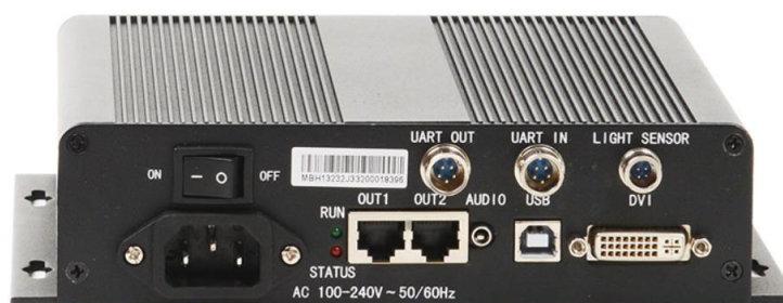
Figura 56. Controladora de la pantalla LED. [40]
