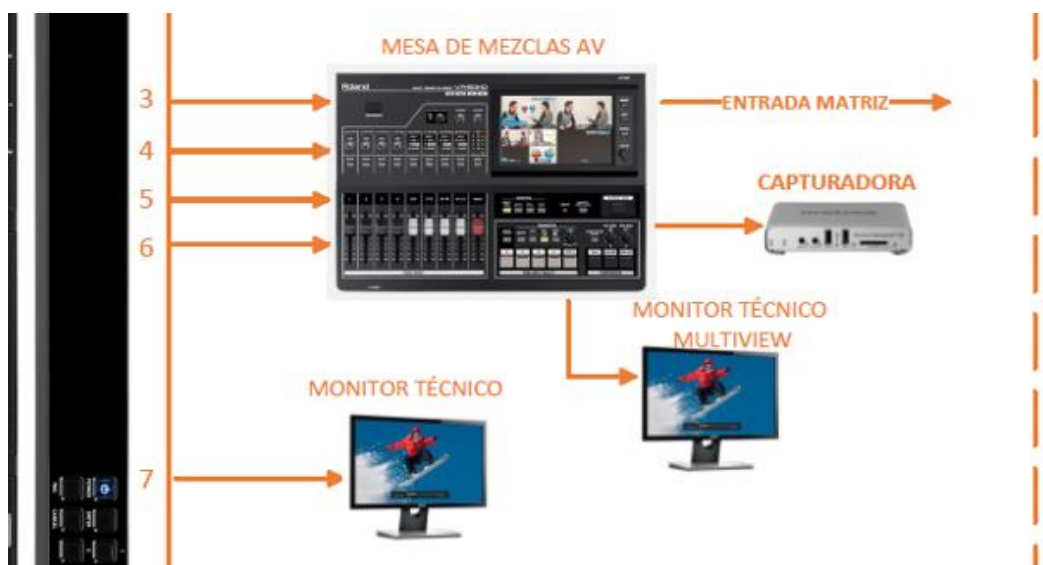
Figura 51. Conexionado de los monitores del sistema de monitorización
