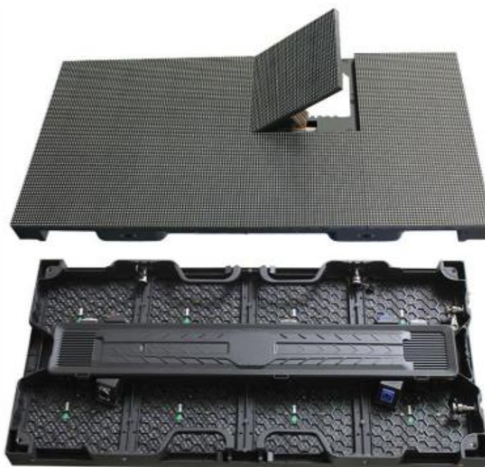
Figura 24. Cabinets y módulos LED [18]
