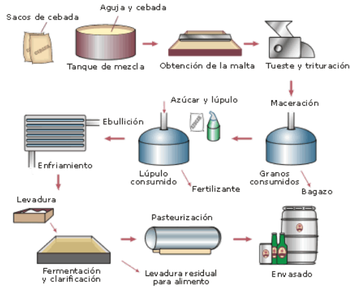
Figura 2 - Esquema de los procesos involucrados en la elaboración de la cerveza (Google imágenes)
