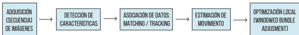
Figura 4. Esquema de funcionamiento en Visual Odometry. Fuente: Elaboración propia.
