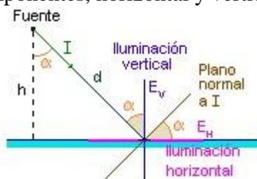
Figura 2.8. Descomposición de la iluminancia en sus componentes vertical y horizontal.
