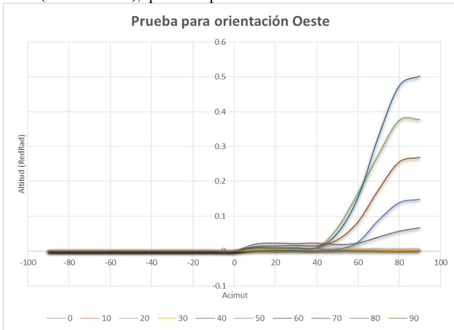
Figura 5.6. Daylight factors para la orientación Oeste con las divisiones de acimut  $\varphi_{RedRad} \in [-90,90]$  y una altura solar  $\theta_{RedRad} \in [0,90]$
