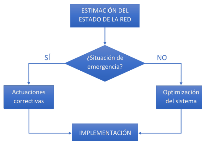
Figura 3. Ejemplo de diagrama de flujo básico del sistema [16].
