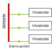
La red de distribución se define mediante dos tipos de tuberías: MONTANTES (tuberías verticales que distribuyen el agua precalentada por todo el edificio) y DERIVACIONES PARTICULARES (tuberías que conectan cada vivienda con uno de los montantes). El número de montantes depende de la configuración del edificio (número de escaleras, etc.). Hay una derivación por vivienda.
