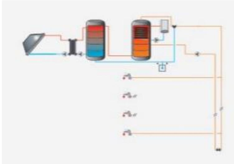
*Figura 17: Instalación para consumo múltiple con todo centralizado*
