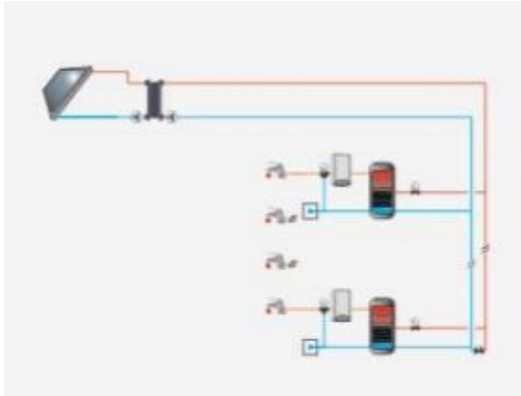
*Figura 9: Instalación para consumo múltiple con acumulación distribuida.*
