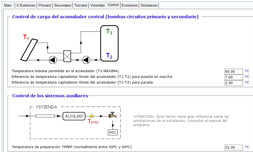
Figura 34: Pantalla de control de la instalación.
