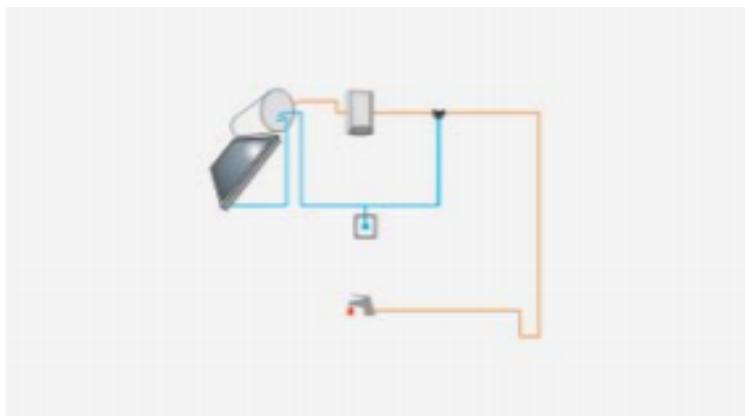
*Figura 13: Instalación para consumo único con sistema prefabricado.*
