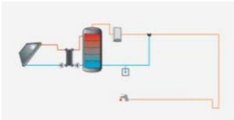
Figura 15: Instalación para consumo único con intercambiador independiente.
