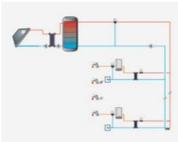
*Figura 10: Instalación para consumo múltiple con intercambio distribuido.*
