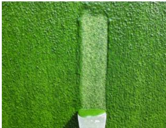
Figura 20: Detalle de un Fotobiorreactor Laminar. Raspado de una de sus láminas [19] .
