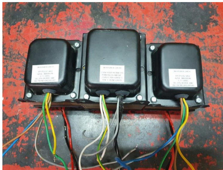
Figura 3-9. Transformadores de audio y de alimentación listos para el montaje en el chasis.
