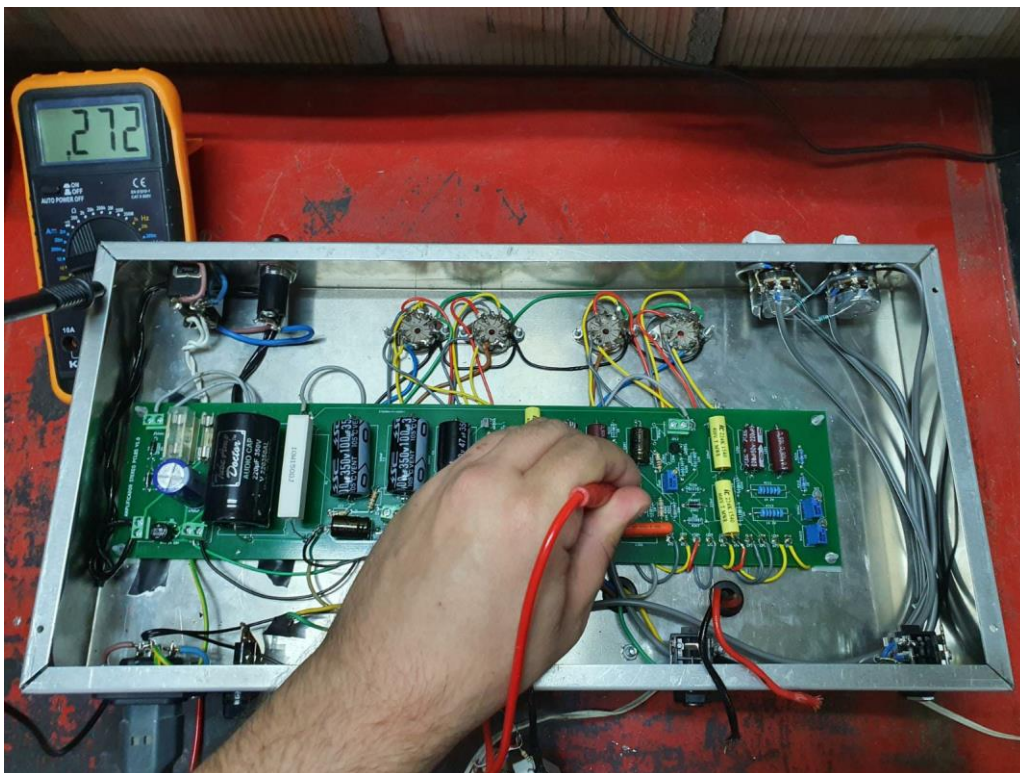
Figura 4-12. Medida del BIAS del primer pentodo.
