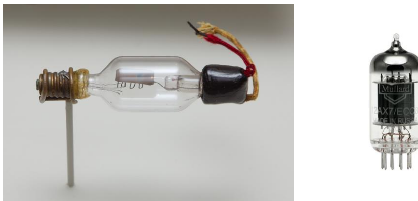
Figura 1-2. Triodo “audiión” de Lee de Forest en 1906 y válvula doble triodo ECC83 actual.
