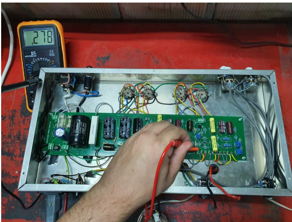
Figura 4-13. Medida del BIAS del segundo pentodo.
