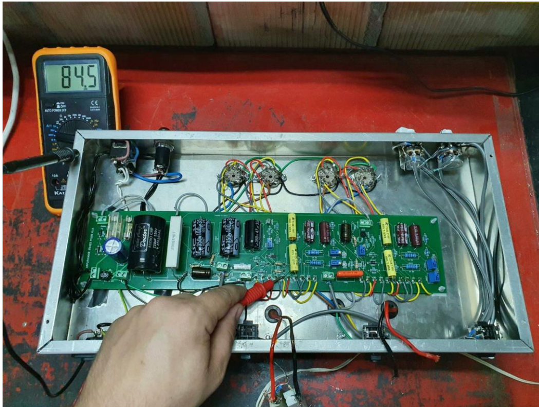
Figura 4-11. Medida de voltaje en el cátodo del inversor de fase.
