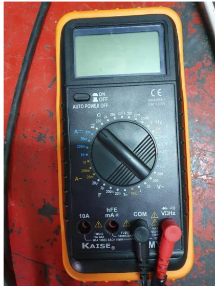
Figura 4-2. Multímetro usado para las pruebas.
