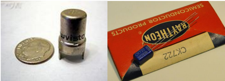
Figura 1-6. Tamaño de un nuvistor con respecto al transistor de germanio CK722
