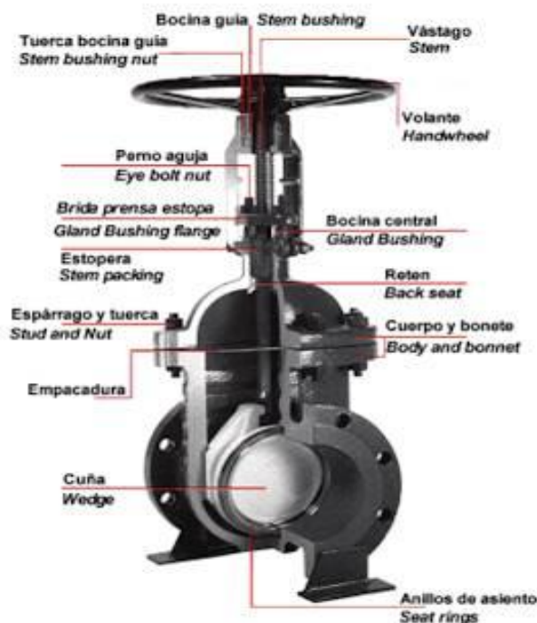
Figura 34. Estructura de una válvula de compuerta (Valvias, 2013)
