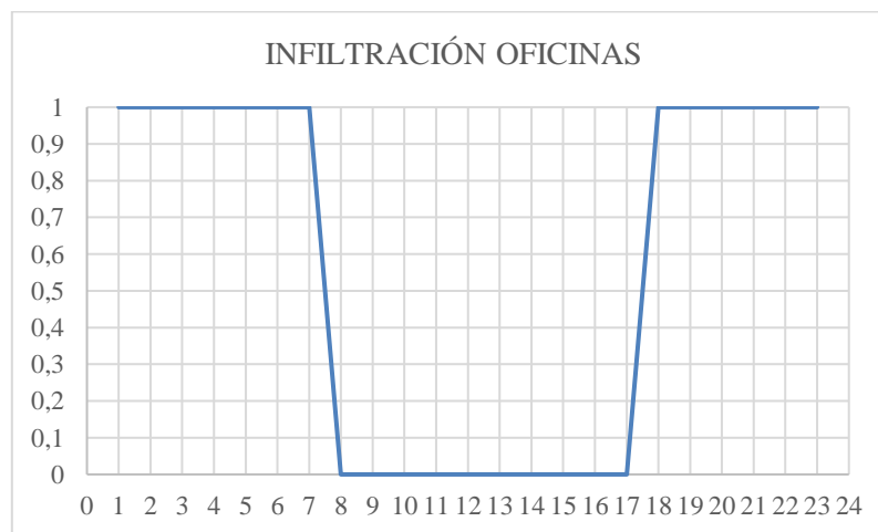
Figura 28. Horarios de infiltración en las oficinas.
