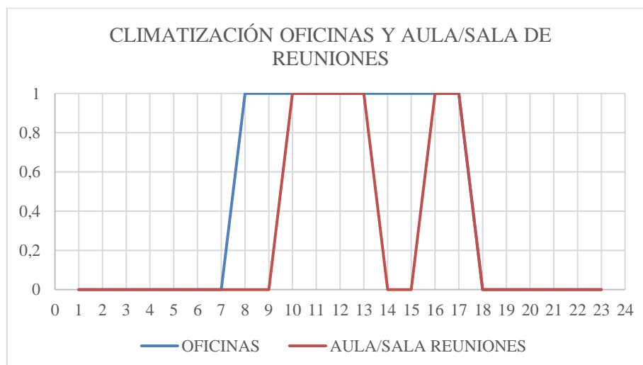
Figura 32. Horario de climatización.
