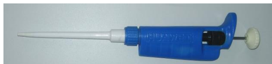
Ilustración 39. Micropipeta NICHIPET EXII 0-200µl.
