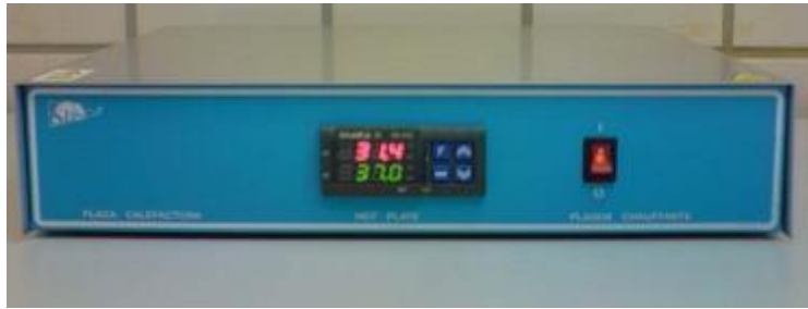
Ilustración 37. Pletina calefactora SBS OSAKA II PK 312.
