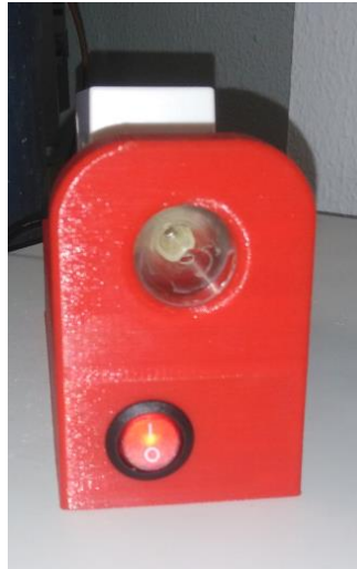
Ilustración 10: Vista frontal de la selladora SafeSealer.
