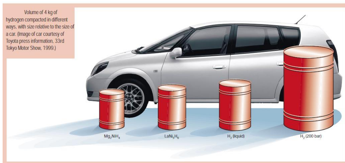
Ilustración 6: Volumen que ocupa una masa de hidrógeno (4 kg) en función del tipo de almacenamiento
