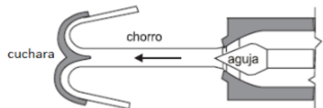
Figura 4-3: Chorro a la salida del inyector. Fuente: http://repositorio.uchile.cl (46)
