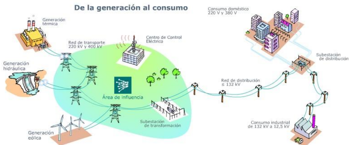
Figura 1-1: Esquema del sistema eléctrico español. Fuente: www.eoi.es (1)
