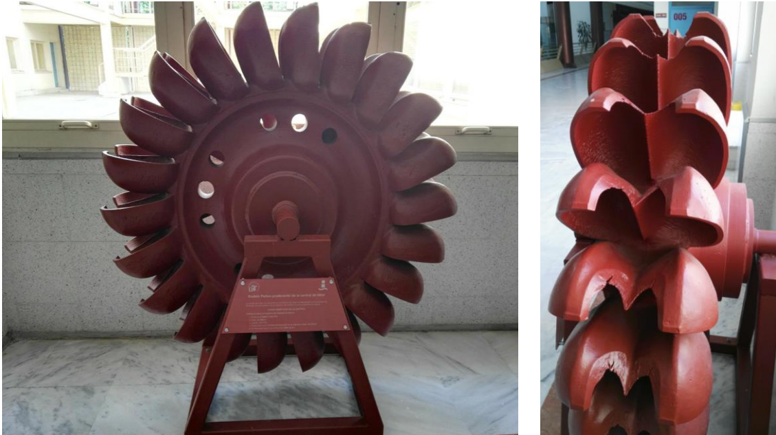
Figura 4-10: Rodete Pelton de la Central de Izbor en la ETSI (Sevilla). Fuente: http://institucionales.us.es (50)
