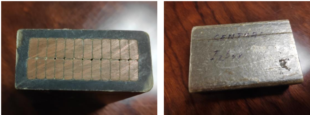
Figura 4-13: Secciones de las barras del alternador sustituido de Izbor. Fuente: Ramón Abella Monserrat.
