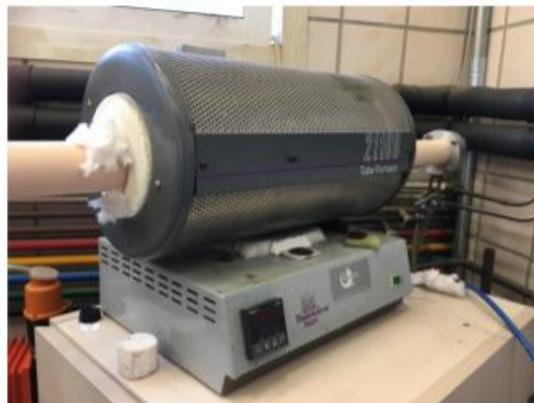
**Figura 42:** Horno tubular Thermolyne 21100
