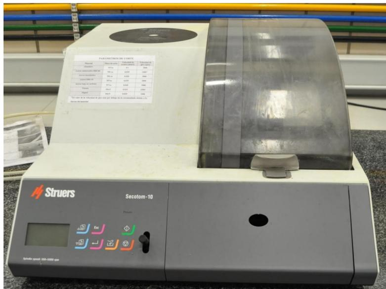
**Figura 49:** Cortadora de precisión Struers Secotom-10
