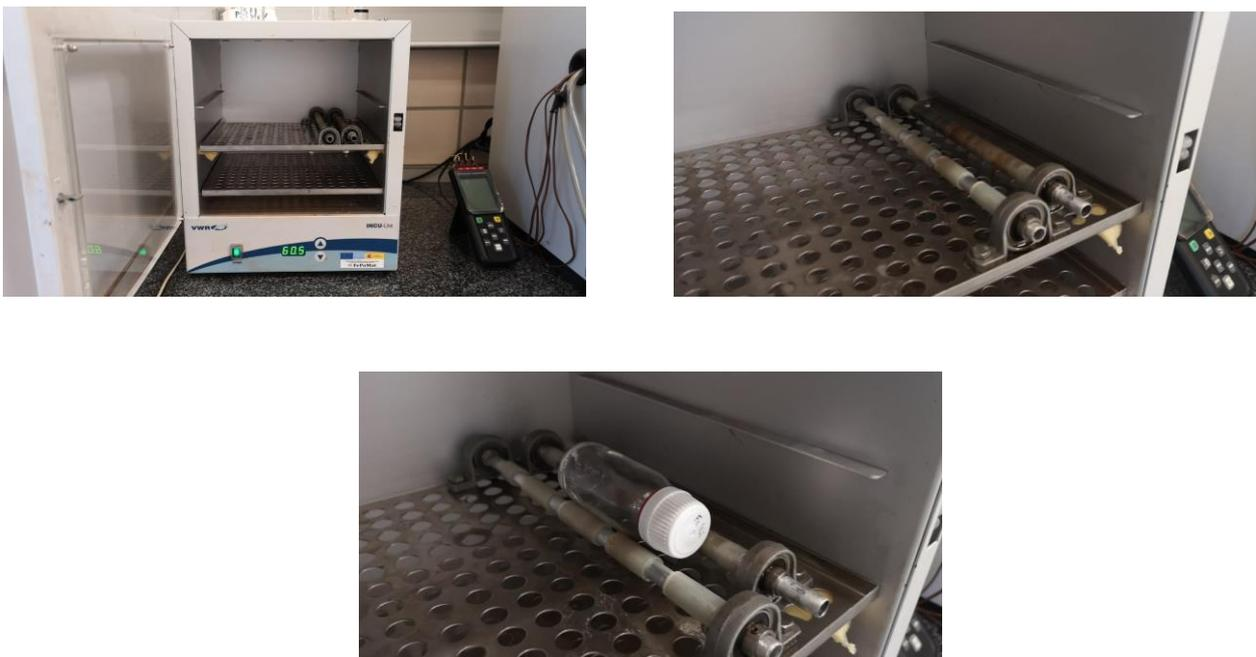
**Figura 34:** Sistema empleado para el mezclado de los componentes que forman la muestra.
