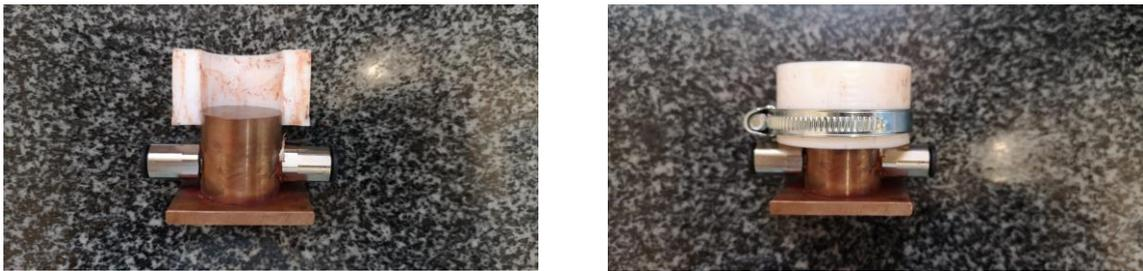
**Figura 35:** Molde empleado durante la solidificación
