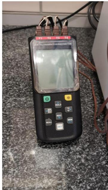
**Figura 37:** Termómetro HH-521BT
