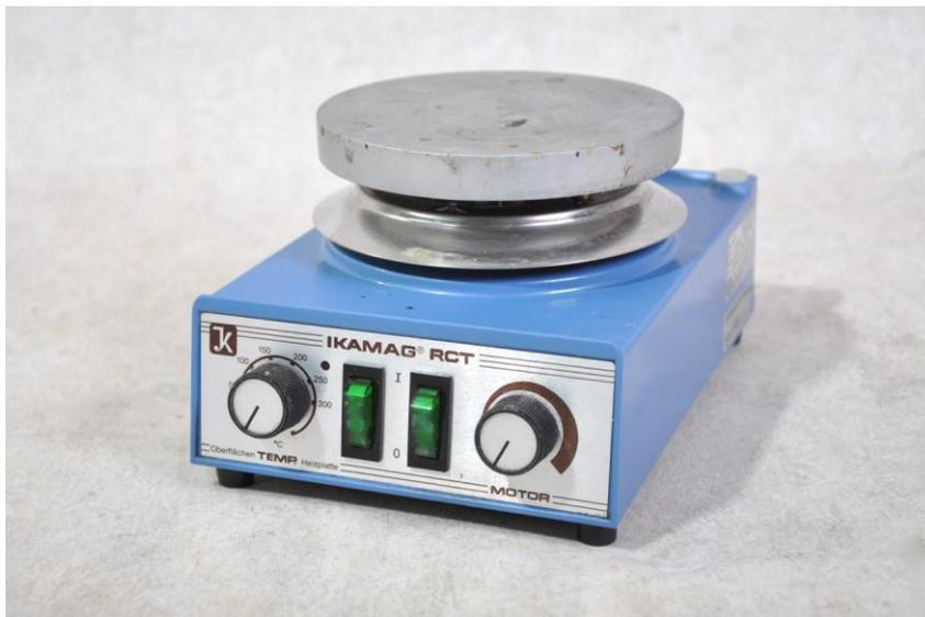
**Figura 46:** Agitador magnético con placa calefactora IKAMAG RCT
