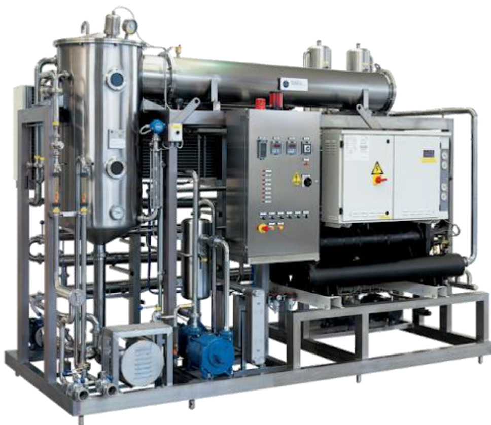
Ilustración 2-2. Ejemplo concentrador de mostos.
