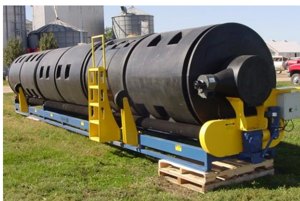
Figura 8. Compostaje en tambor rotatorio. (Tortosa, 2011)
