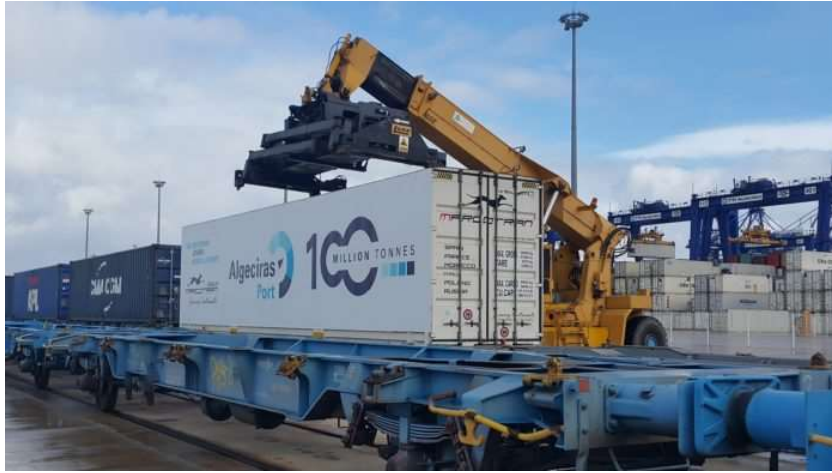
Ilustración 4.15 Grúa apiladora trabajando sobre un tren en el Puerto de Algeciras
