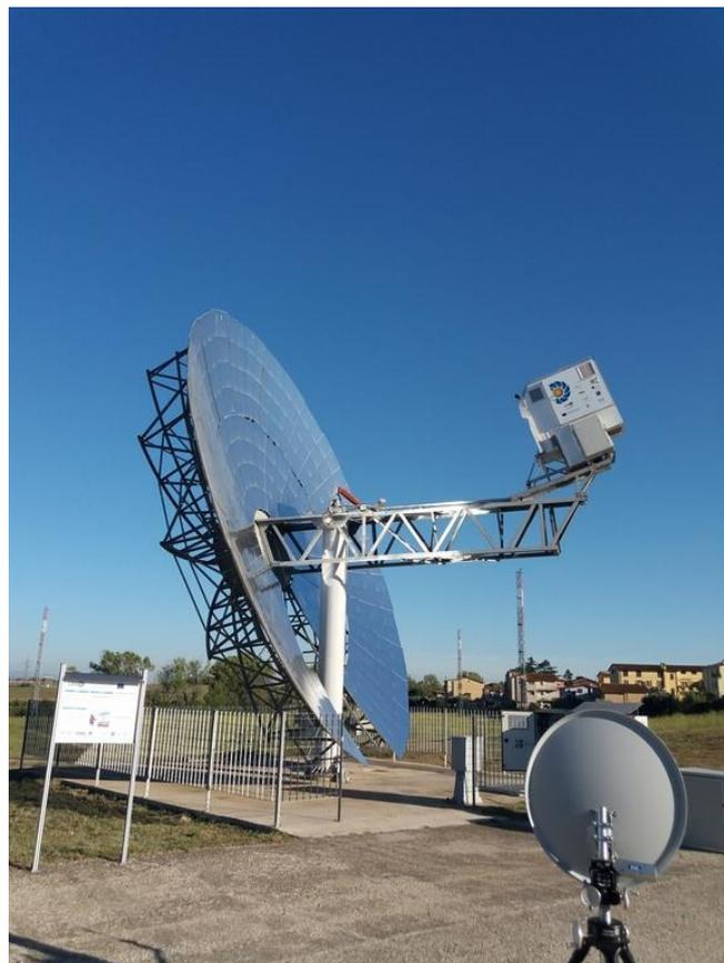
**Figura 14.** Captador paraboloide del proyecto OMSoP en ENEA SOLAR [26].
