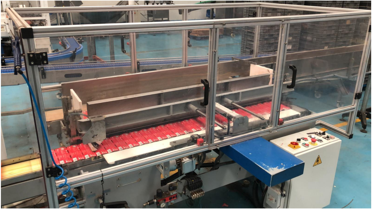
Figura 14. Apilador tripack Estuches MA-383/54. Fuente: Elaboración propia.
