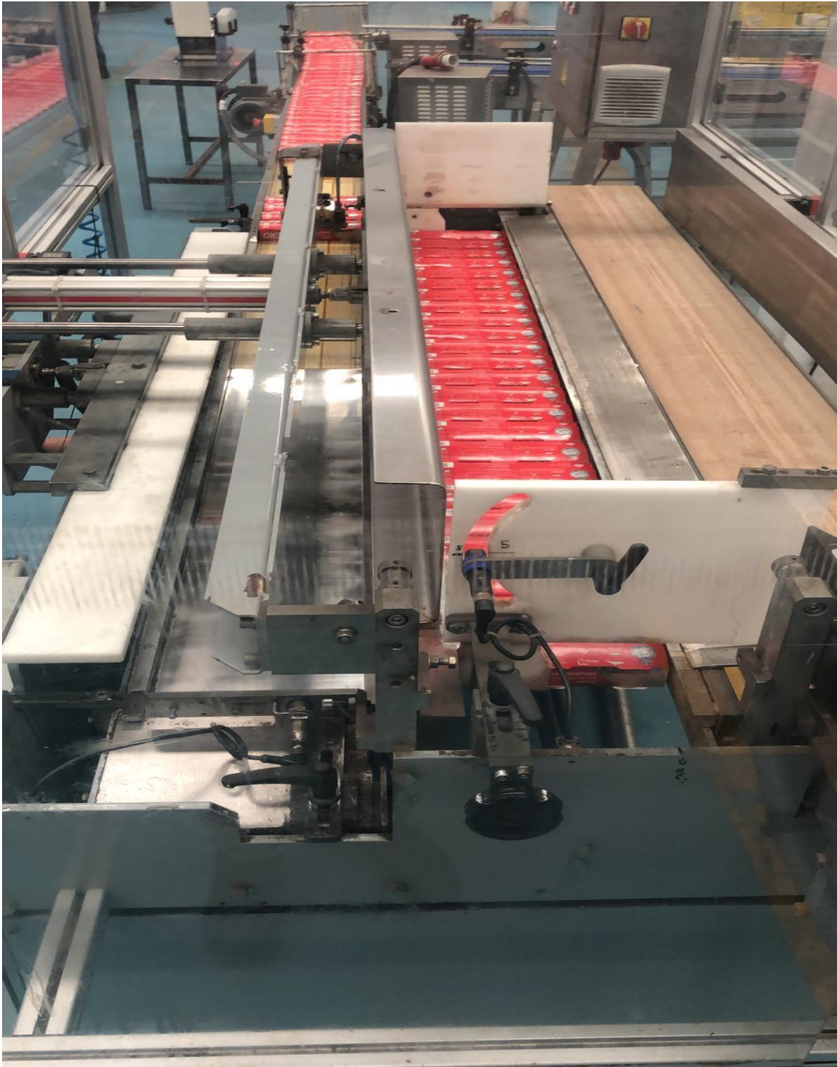
Figura 33. Punto crítico donde se produce el atasco del apilador (Tramo A-B figura 31). Fuente: Elaboración propia
