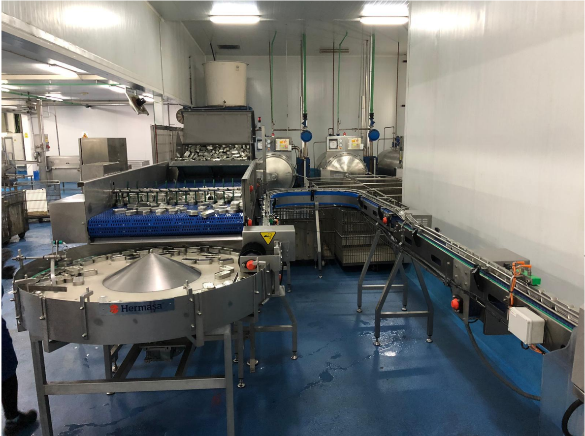
Figura 6. Imagen en planta de la línea de alineado de envases. Fuente: Elaboración propia.
