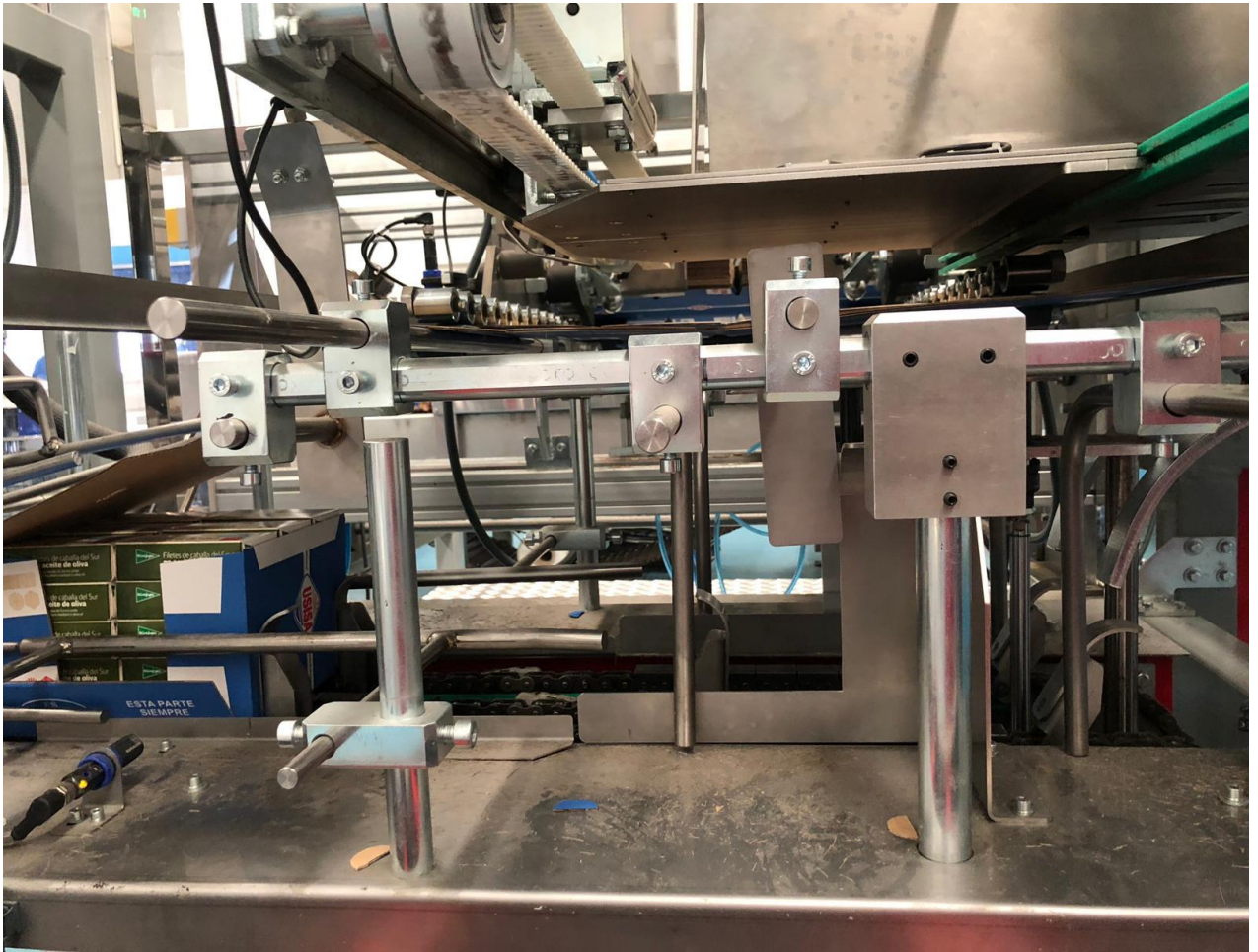
Figura 23. Imagen de la encajonadora Wrap-Around en funcionamiento. Fuente: Elaboración propia.
