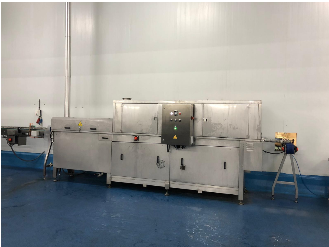
Figura 7. Imagen en planta de la lavadora secadora lineal. Fuente: Elaboración propia.
