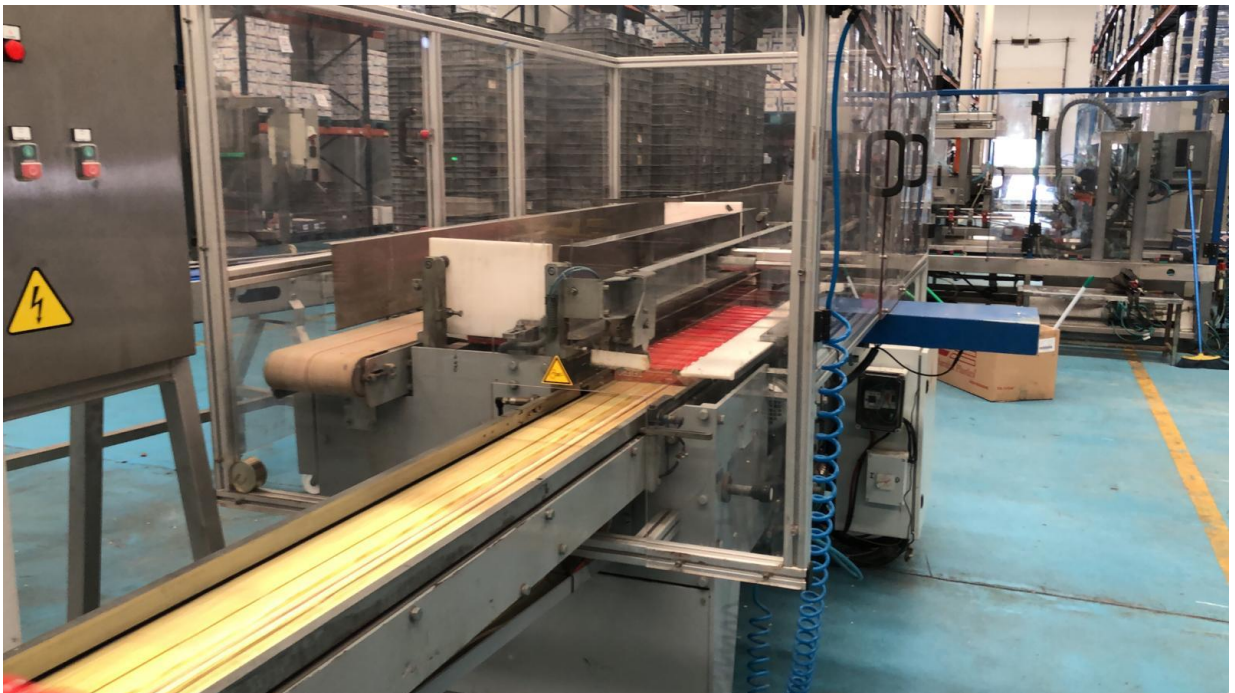
Figura 15. Apilador tripack Estuches MA-383/54 y encajonadora DEDIME DED-15. Fuente: Elaboración propia.
