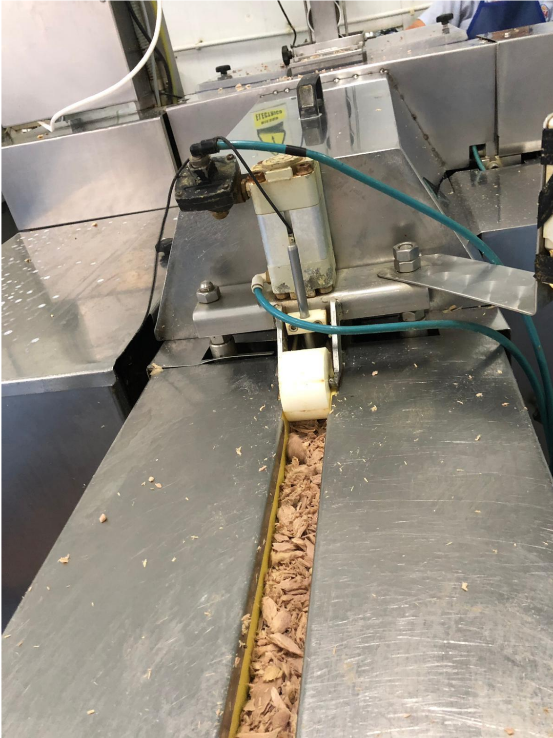
Figura 29. Imagen de la empacadora de atún en funcionamiento. Fuente: Elaboración propia
