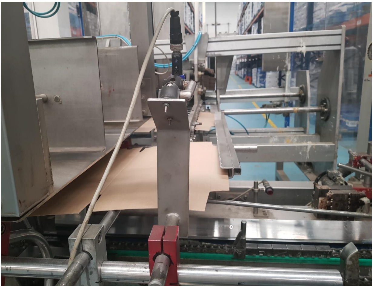
Figura 32. Alimentación del cartón de la encajonadora de packs de 3. Fuente: Elaboración propia.
