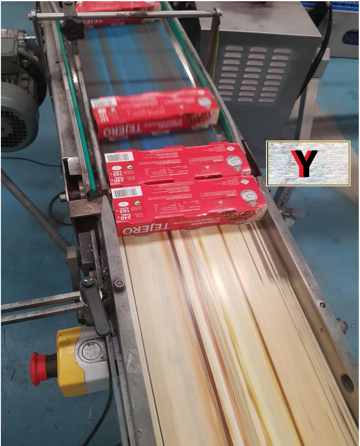
Figura 36. Punto crítico Y donde se produce el cambio de posición no deseado. Fuente: Elaboración Propia.
