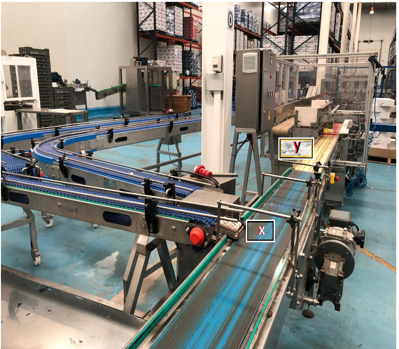
Figura 34. Puntos críticos X, Y en el tramo antes del apilador de pack de 3. Fuente: Elaboración propia.
