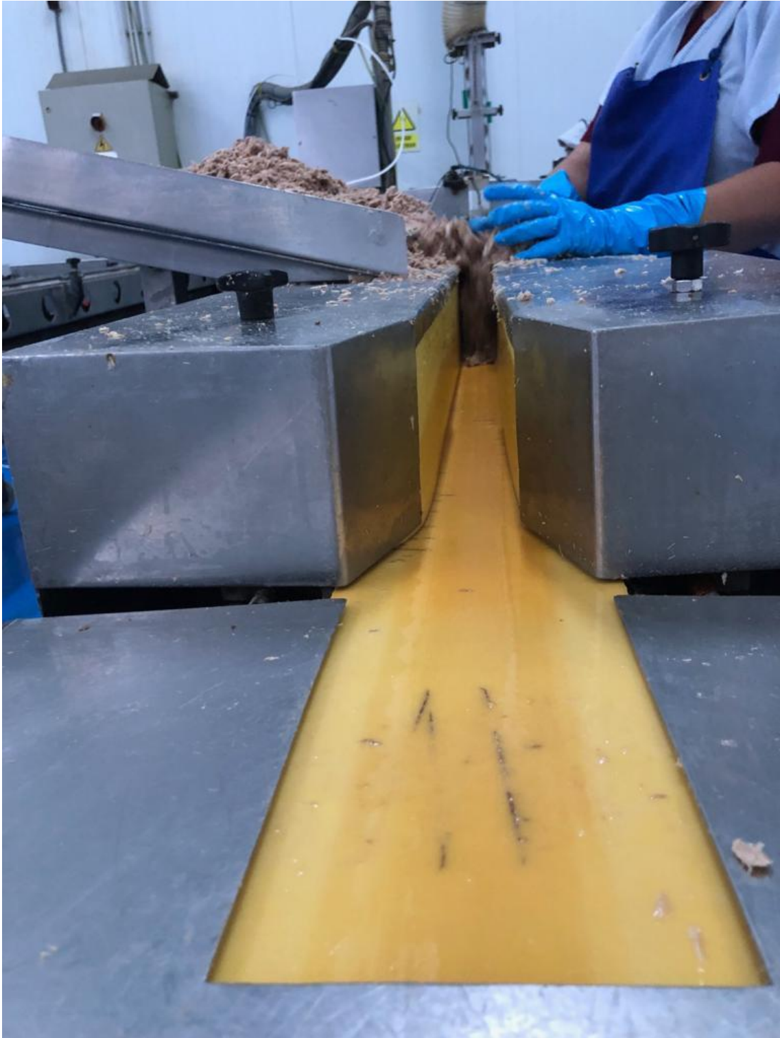
Figura 28. Imagen de la empacadora de atún en funcionamiento. Fuente: Elaboración propia.
