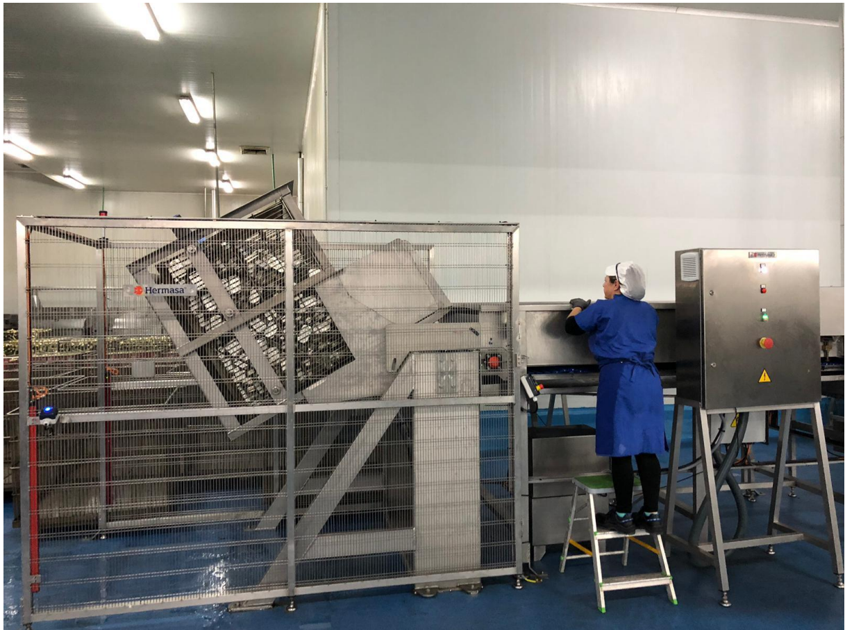
Figura 5. Imagen en planta del volteador de carros. Fuente: Elaboración propia.
