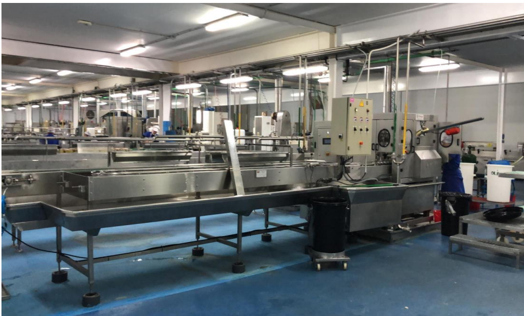
Figura 12. imagen en planta de la máquina dosificadora de cobertura y máquina cerradora de latas. Fuente: Elaboración propia.
