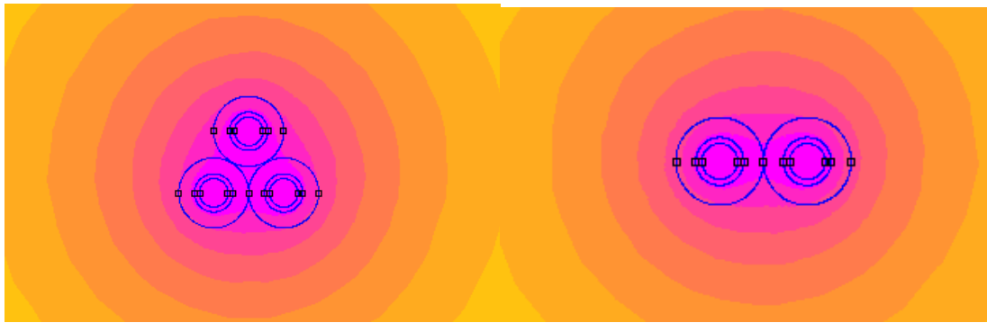
Figura 3-5. Análisis térmico de los dos sistemas citados anteriormente
