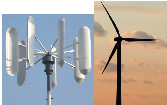
Figura 1.5: Aerogenerador de eje vertical [izquierda] y aerogenerador de eje horizontal [derecha]. Fuente: Consultar [4].
