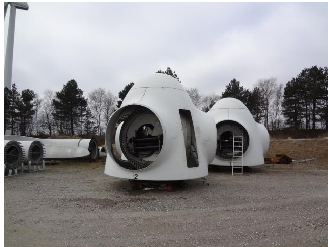
Figura 2.2: Buje de aerogenerador con mecanismo para el control del ángulo de paso. Fuente: Consultar [12].
