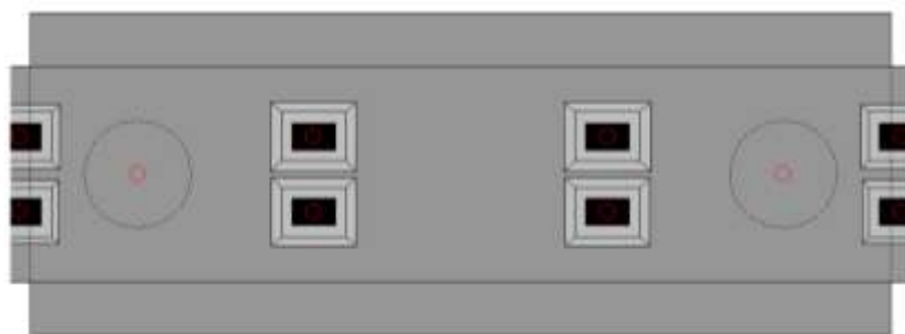
Ilustración 7.17 Situación de apoyos en una de las pilas. Fuente: El. prop.
