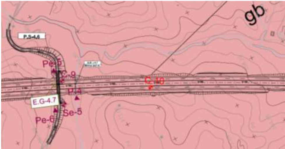
Ilustración 6.5. Vista en planta de la cartografía geológico-geotécnica del emplazamiento. Fuente: Proyecto Original
