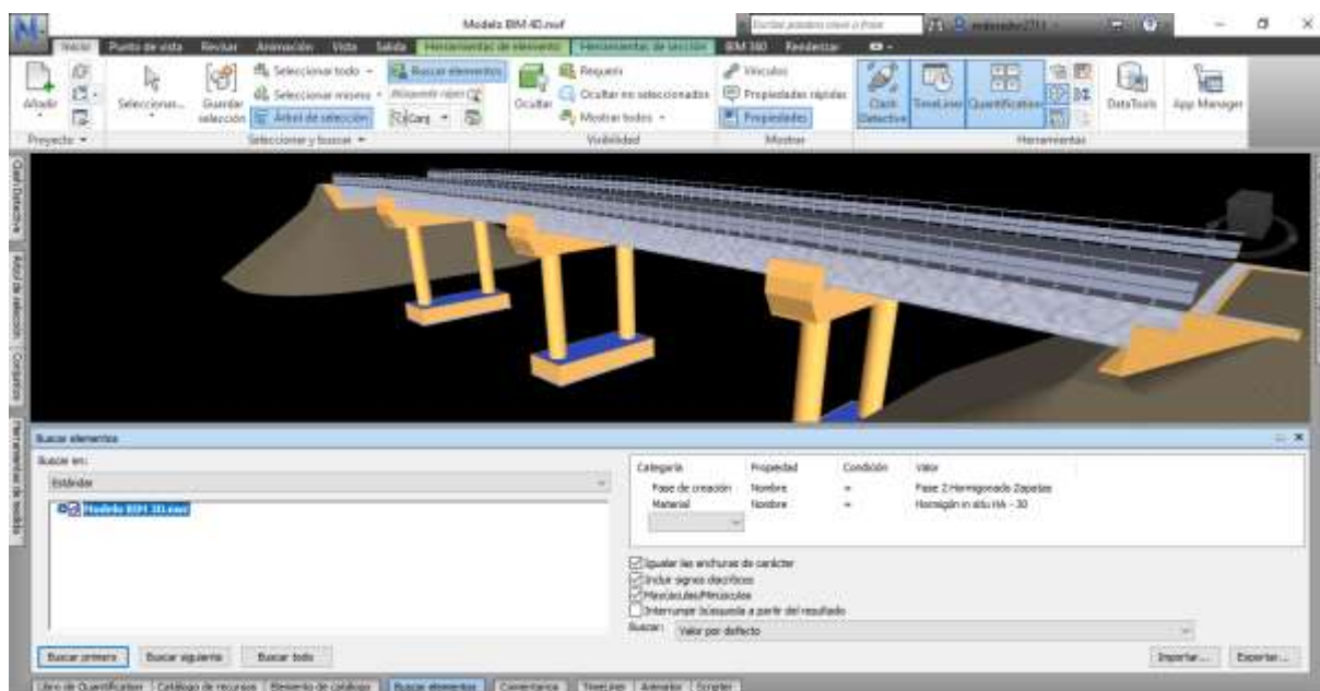
Ilustración 9.17 Creación de Conjuntos de Búsquedas en Navisworks®. Fuente: El. prop.
