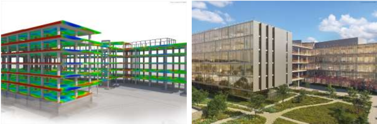
Ilustración 8.2 Modelo analítico en Robot® (izda.) vs Modelo final en Revit® (dcha.). Fuente. Autodesk, Inc.
