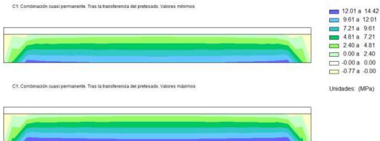
Ilustración 7.7 Valores mínimos y máximos de las tensiones en la Viga 2 para la combinación cuasi-permanente tras la transferencia de pretensado. Fuente: El. prop.
