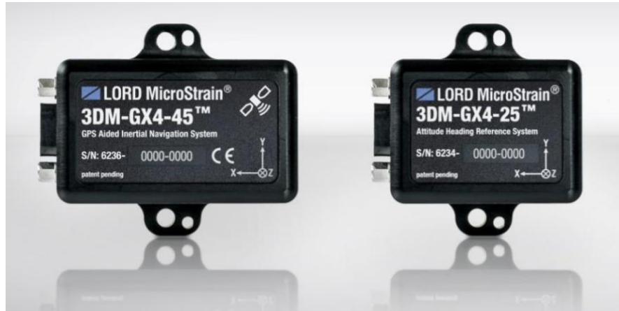
Figura 2-3. Comparativa física modelos IMU 3DM-GX4-45 y 3DM-GX4-25. [3] [4]
