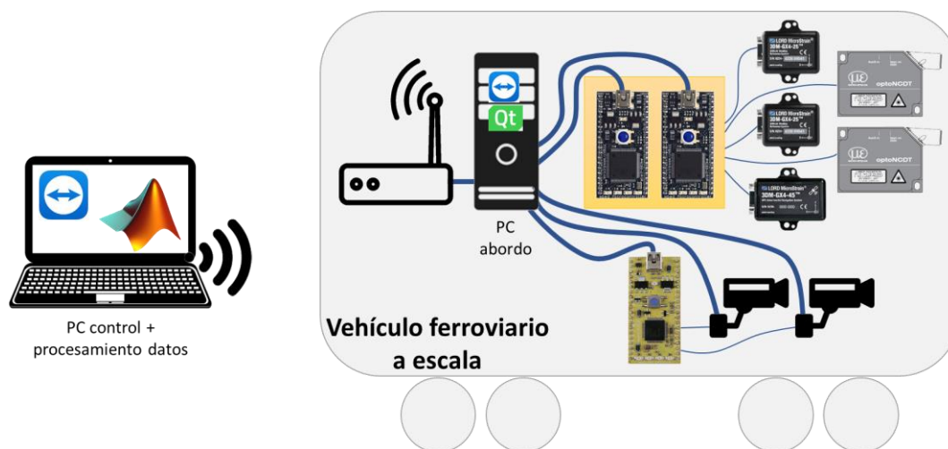
Figura 2-1. Esquema equipamiento y conexiones de sistema de adquisición de datos
