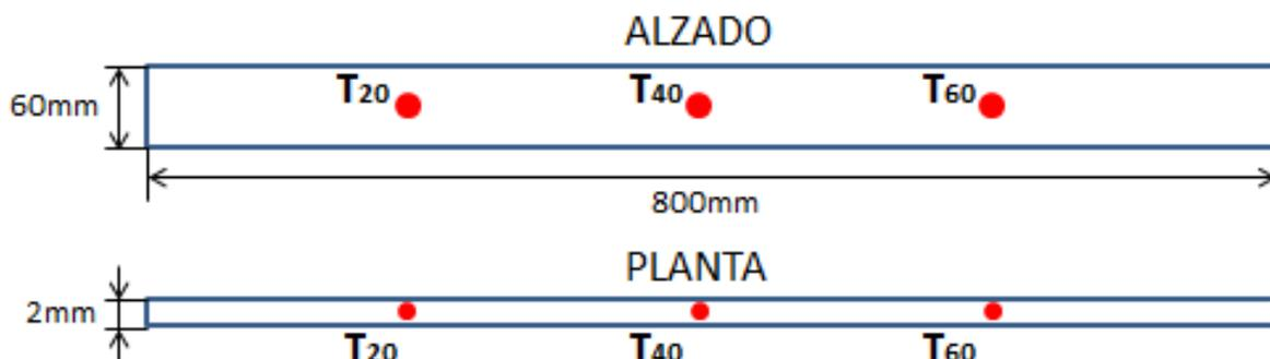
Figura 4.1. Posición de los termopares en el tubo
