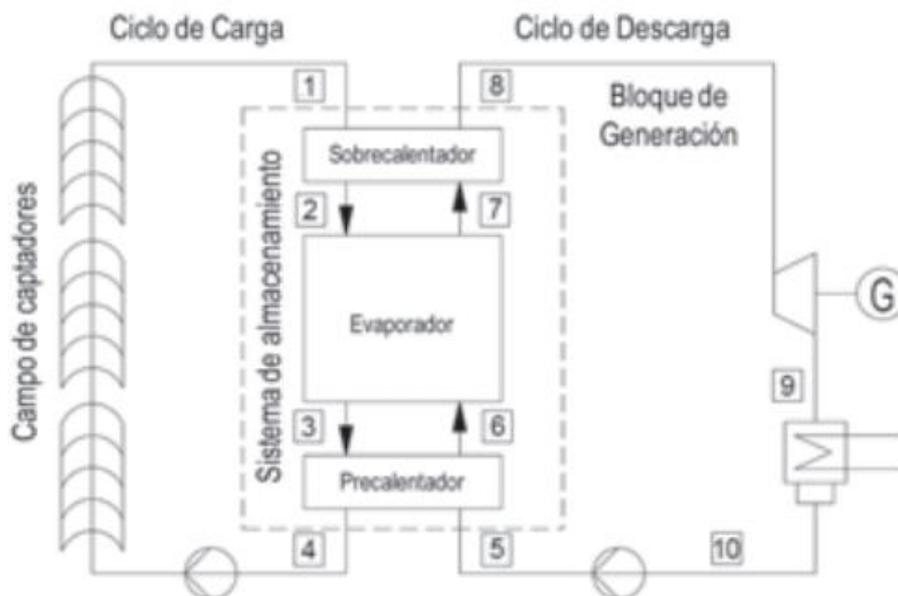
Figura 2.6. Esquema sistema de generación directa de vapor
