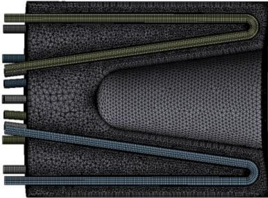
Figura 4.9. Detalle del mallado de la sección simétrica
