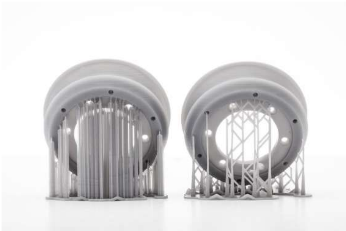
Ilustración 32. Ejemplo de una pieza que necesita de material de soporte para ser fabricada.
