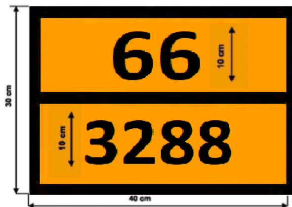
Figura 23. Dimensiones para el panel naranja de la cisterna del Grupo 3288. Fuente: ADR
