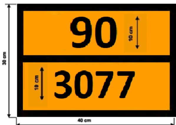
Figura 24. Dimensiones para el panel naranja de la cisterna del Grupo 3077. Fuente: ADR
