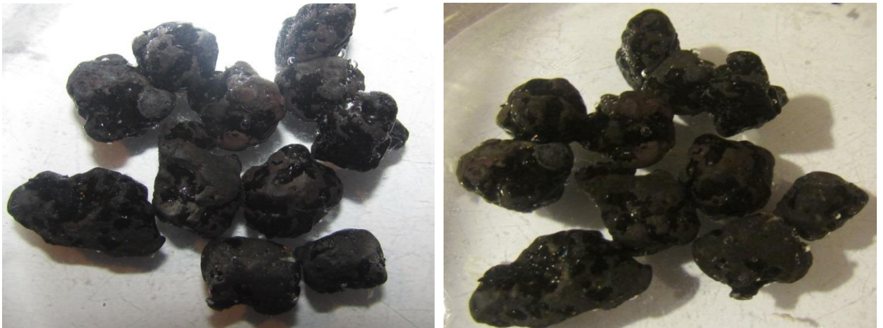
Figura 4-13. Escoria de acero después de 24 horas de ensayo
