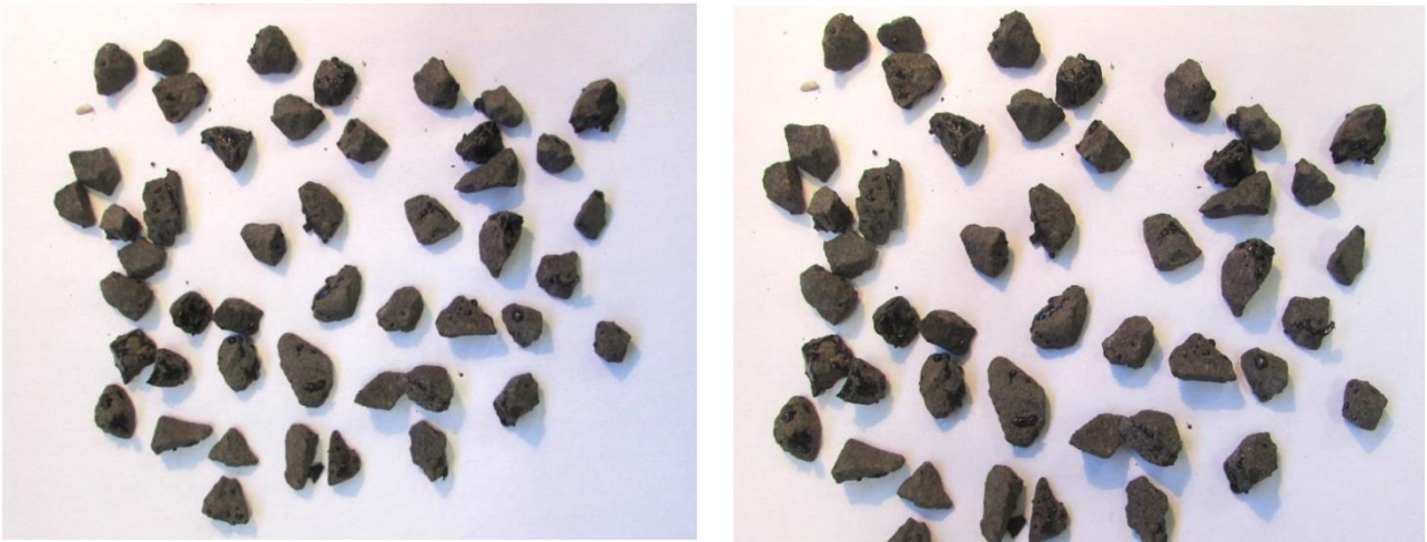
Figura 4-24. Basalto después de 3 minutos de ebullición – primera muestra
