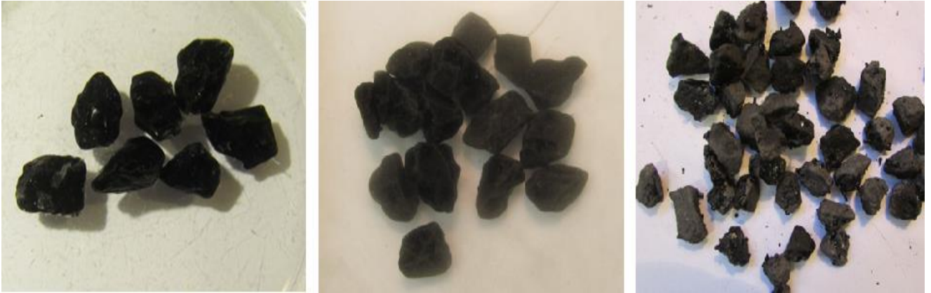
Figura 4-32. Comparación de basalto después de la prueba de botella rodante (6h, 24h) y después de la prueba de ebullición
