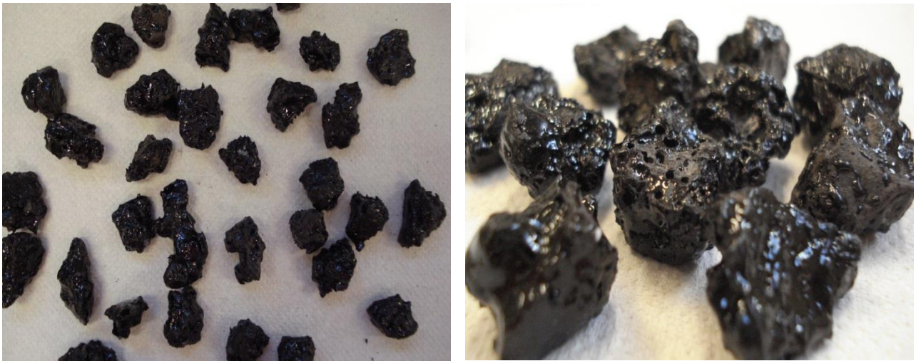
Figura 4-26. Escoria de fabricación de acero después de 3 minutos: primera muestra
