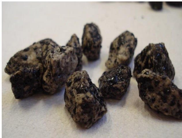
Figura 4-23. Granito después de 3 minutos de ebullición – segunda muestra
