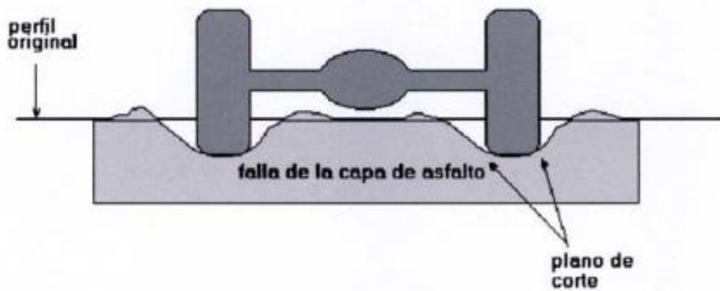
Figura 5-2. Roderas debidas al fallo de la capa de rodadura. (Alejandro Padilla, estudio UPC)
