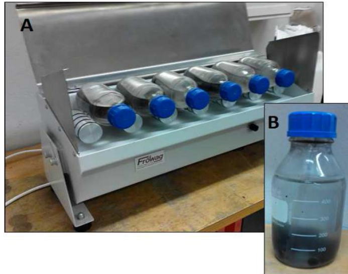
Figura 4-4. Máquina de rotación de botellas (A) y botella de prueba (B)
