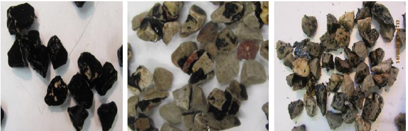
Figura 4-33. Comparación de caliza después de la prueba de botella rodante (6h, 24h) y después de la prueba de ebullición
