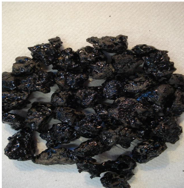
Figura 4-27. Escoria de fabricación de acero después de 3 minutos de ebullición – segunda muestra.
