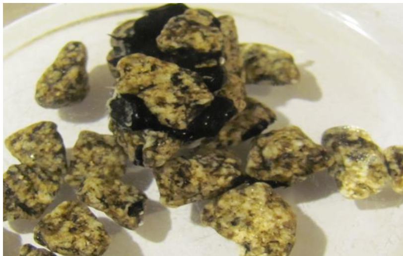
Figura 4-9. Granito después de 24 horas de ensayo
