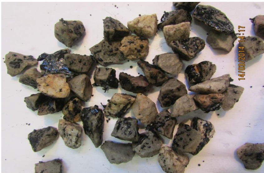
Figura 4-29. Piedra caliza después de 3 minutos de ebullición – primera muestra
