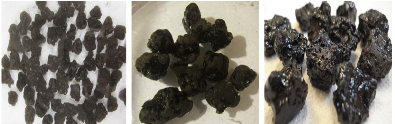
Figura 4-34. Comparación de la escoria de fabricación de acero después de la prueba de botella rodante (6h, 24h) y después de la prueba de ebullición
