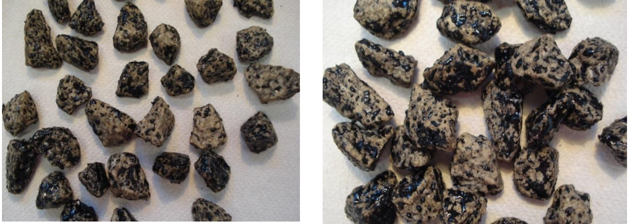
Figura 4-22. Granito después de 3 minutos de ebullición – primera muestra
