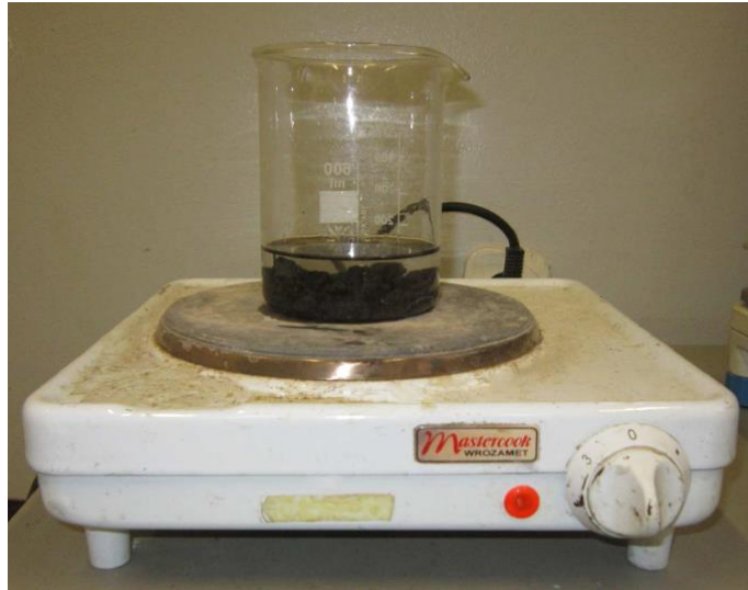
Figura 4-1. Calentamiento de vaso de precipitación con agua destilada y áridos recubiertos de betún
