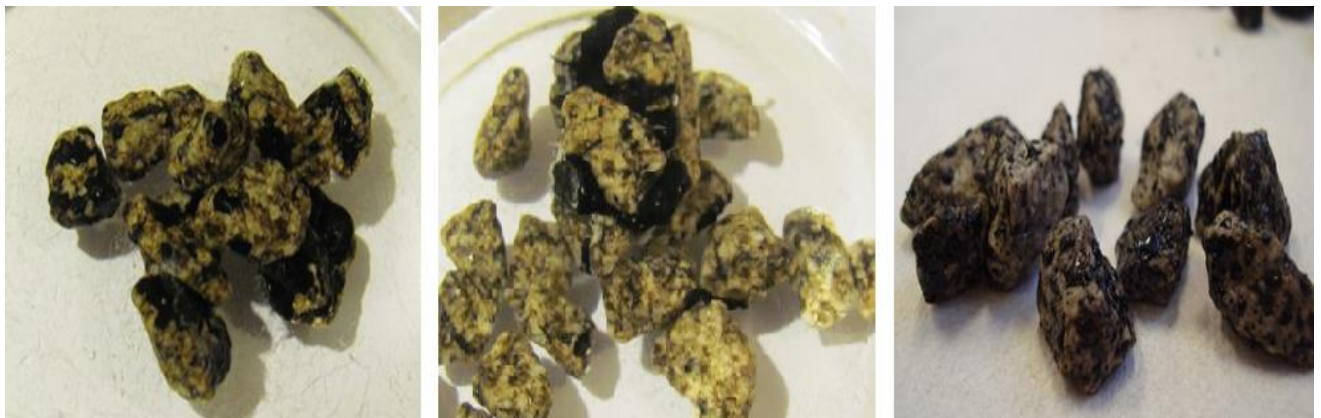
Figura 4-31. Comparación de granito después de la prueba de botella rodante (6h, 24h) y después de la prueba de ebullición
