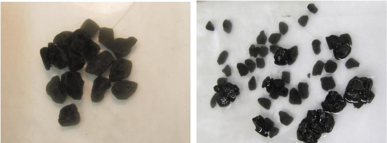
Figura 4-11. Basalto después de 24 horas de ensayo
