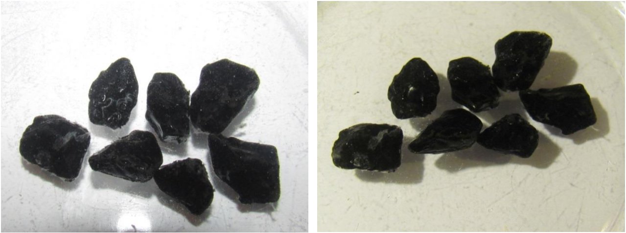
Figura 4-10. Basalto después de 6 horas de ensayo
