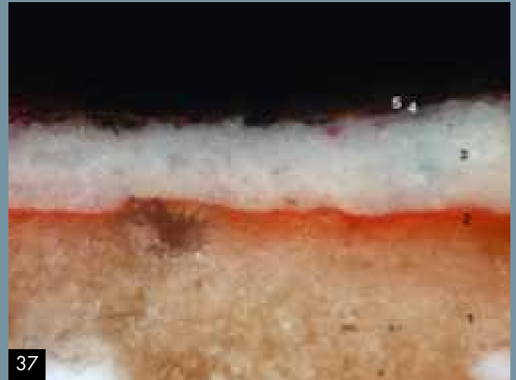
Figura 37. Imagen obtenida al microscopio óptico de la sección transversal de la micromuestra M-DR.07 (objetivo MPlan 10 X / 0, 25). Observación con luz UV. Se puede apreciar la fluorescencia blanquecina de la capa de barniz (capa 5)
