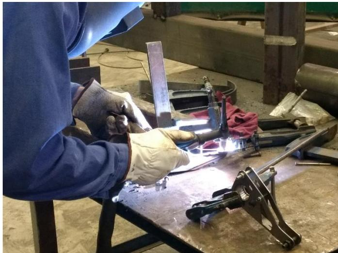
Figura 48. Soldadura rocker delantero
