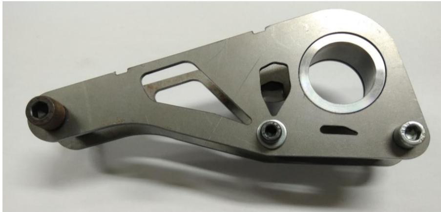
Figura 47. Componentes del rocker delantero
