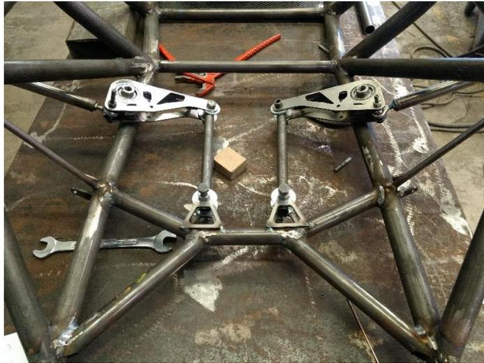
Figura 50. Montaje suspensión
