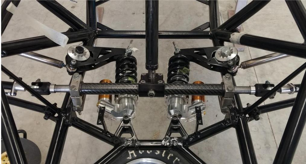
Figura 52. Montaje final suspensión delantera
