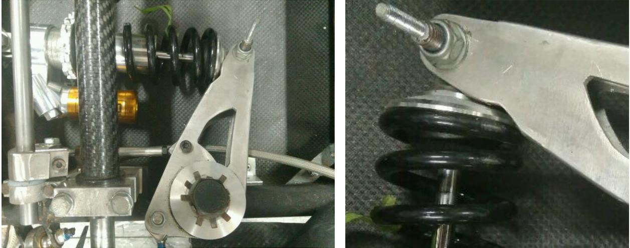
Figura 17. Interferencia rocker-amortiguador ART-16
