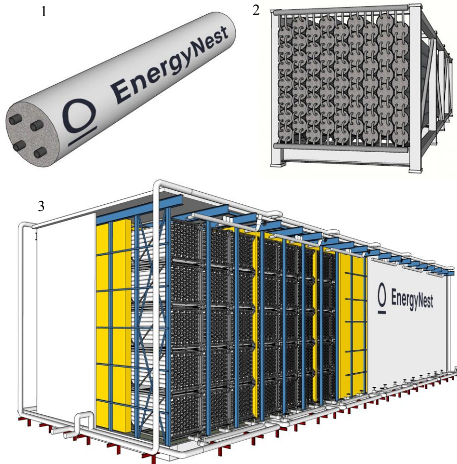
Figura 37: Elementos principales del sistema de almacenamiento térmico de EnergyNest. [48]
