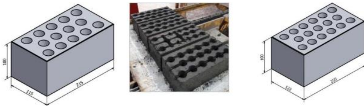
Figura 61: Medidas ladrillo comercial; Ladrillo hueco de hormigón Heatek-RV; Medidas ladrillo hueco Heatek-RV. [44]
