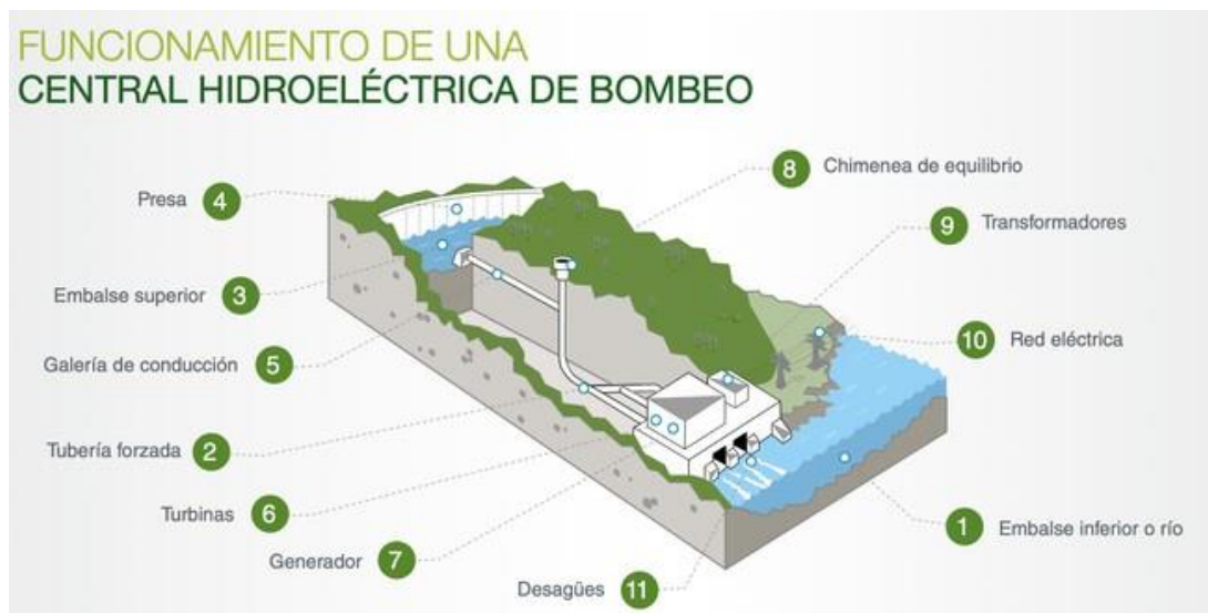
Figura 3: Funcionamiento de una Central Hidroeléctrica de Bombeo. [12]
