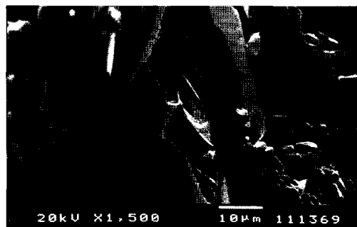
Figura 3 Imagen de la estructura de la caliza de Hontoria vista en el microscopio electrónico de barrido 1.500 veces ampliada
