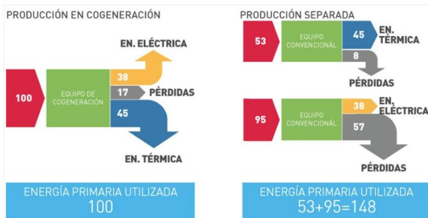
Figura 12: Diferencias entre la cogeneración y la generación convencional
